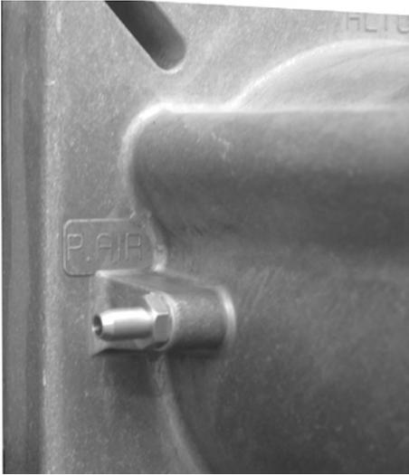
Fig. 21a - Toma de presión aire ventilador
