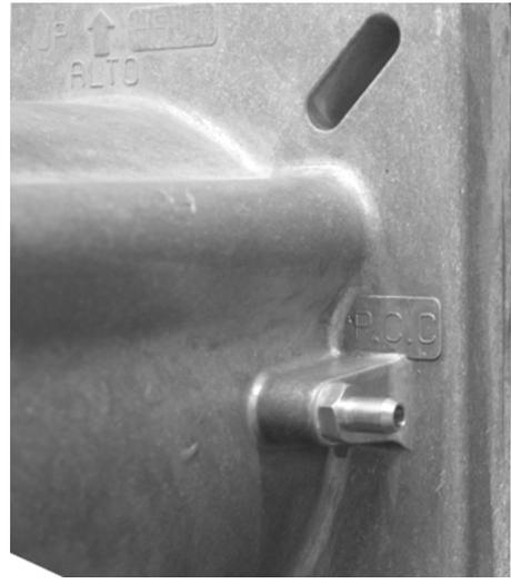
Fig. 21b - Toma de presión cámara de combustión
